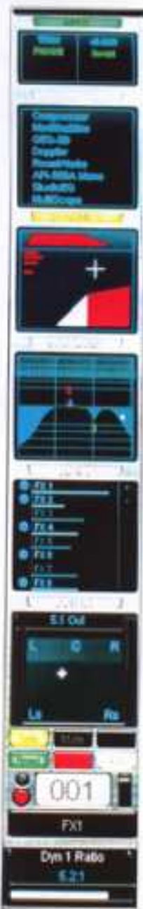
Figure 1 : Chaque tranche physique est prolongée par une extension virtuelle apparaissant dans son alignement sur l'écran tactile.
